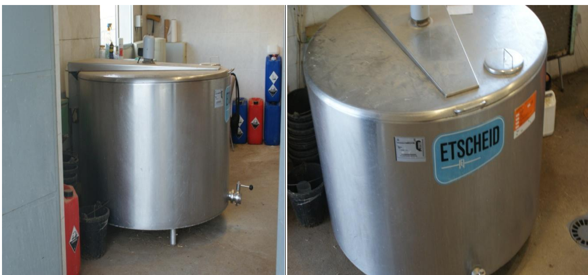
Lote nº 6: Depósito de acero inoxidable de 1.000 litros de capacidad con refrigeración.
