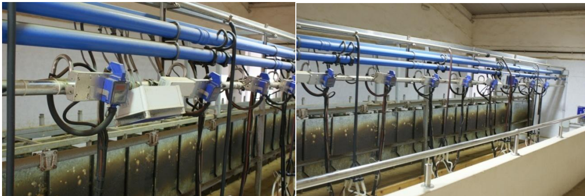
Lote nº 3: Sistema de ordeño compuesto por 10 unidades de ordeño, pulsación, 20 pezoneras y medición electrónica.
